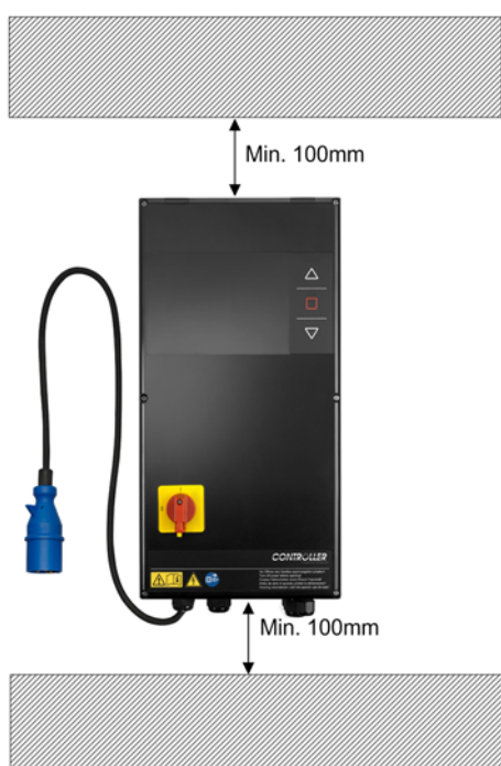
Abbildung 1: Montage der Steuerung
